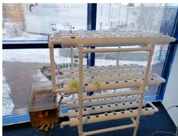
Abbildung 2: Aquaponik-Anlage mit Aquarium und Rohrsystem
